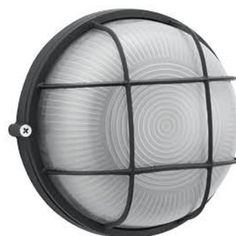
Product Code : 2121 BH Material : Aluminium Die Casting + Glass Finish : Sandy Black Dimension : Ø 180 mm Holder : E27 | IP Rating: IP 54
